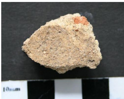
17. kép: A 2/7 falképtörredék Plextol réteggel a felületén
