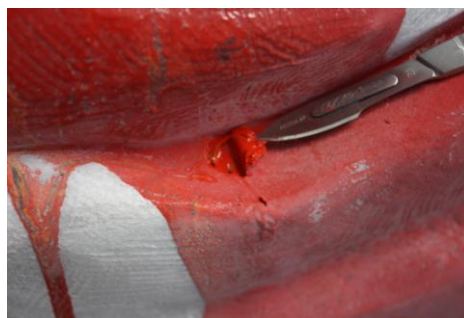
30. kép: A felgyülemlett festékréteg a felszín alatt még puha
