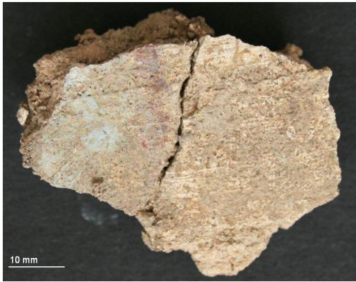
9. kép: A 4/10 falképtöredék lézeres tisztítás előtt
