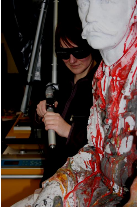
49. kép: A szobor lézeres tisztítása
