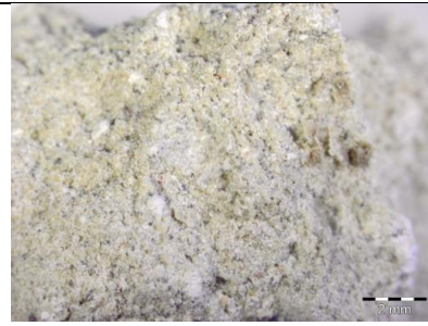
A vakolatminta felszíne (sztereó-mikroszkóp, 0,8 x obj.)
