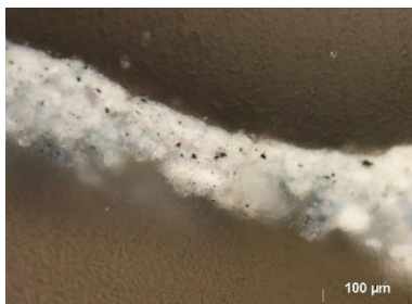
111. kép. C7 minta, szürke aláfestés, keresztmetszet-csiszolat (PLM. 10 x obj.)
