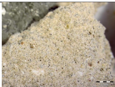
A vakolatminta törésfelülete (sztereo-mikroszkóp, 0,8 x obj.)
