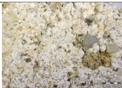
A vakolatminta törésfelülete (sztereo-mikroszkóp, 0,8 x obj.)
