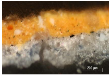
106. kép. Szürkés-kék aláfestésen sárga festékréteg, keresztmetszet-csiszolat (C9), (PLM. 20 x obj.)
