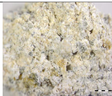
A habarcsminta frissen tört felülete (sztereo-mikroszkóp, 0,8 x obj.)
