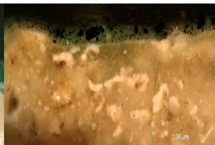
185. kép. (BSZ-Z1.), kén-hidrogén gőz hatására a zöld szemcsék elfeketedtek, PLM. 10 x obj.
