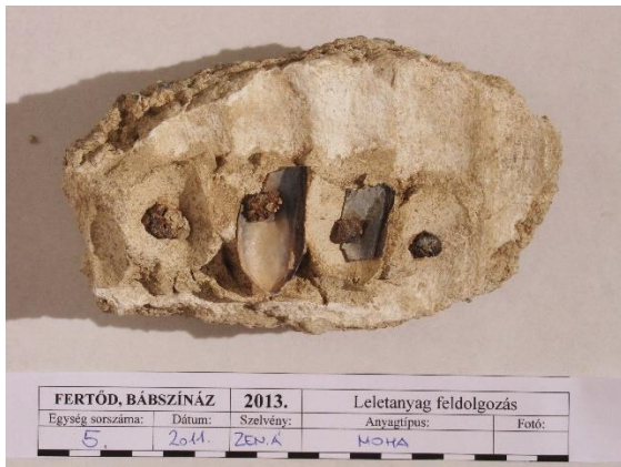
157. kép. Stukkóba szegekkel rögzített kagylóhéjak habarcs alátöltésen
