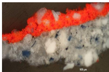
97. kép. Szürkéskék aláfestésen egyenletlen vastagságú (általában 50-100 μm) élénk vörös festékréteg, keresztmetszet-csiszolat (C5), (PLM. 20 x obj.)
