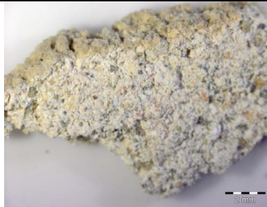
A habarcsminta törésfelülete (sztereo-mikroszkóp, 0,8 x obj.)
