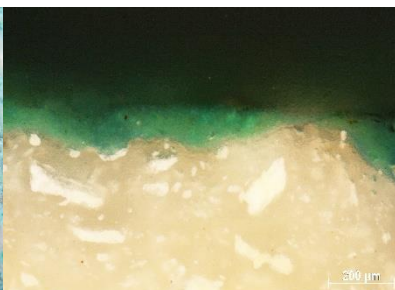
184. kép. Stukkóminta (BSZ-Z1.), keresztmetszet-csiszolat, PLM. 10 x obj.
