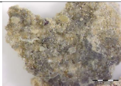
A vakolatminta felszíne (sztereo-mikroszkóp, 0,8 x obj.)
