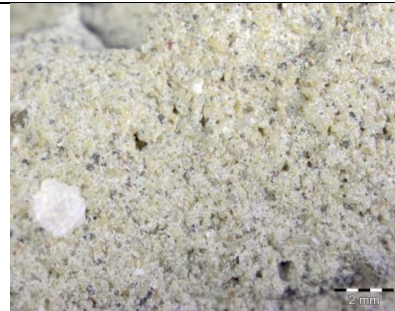
A vakolatminta törésselülete (sztereo-mikroszkóp, 0,8 x obj.)
