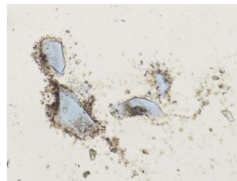
212. kép. Szemcsepreparátum, PLM. 20 x obj., smalte szemcsék
