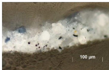
91. kép. Szürke aláfestésen kék festékréteg, keresztmetszet-csiszolat (C4), (PLM. 20 x obj.)
