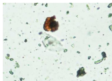
216. kép. Szemcsepreparátum, PLM. 20 x obj., barna okker szemcsék
