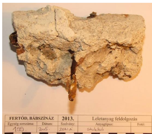
141. kép. Vakolat hordozóhoz való rögzítésére alkalmazott szegek
