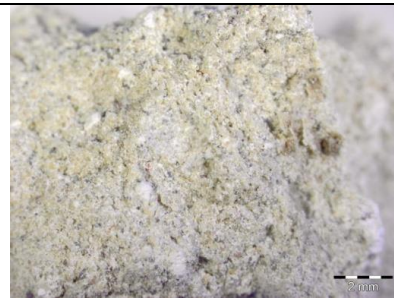
A vakolatminta felszíne (sztereó-mikroszkóp, 0,8 x obj.)
