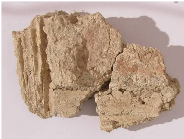
174. kép. Téglalenyomat, vízszintes gerenda és nádazás nyoma vakolattörédeken, normál felvétel, szerkezeti rajz
