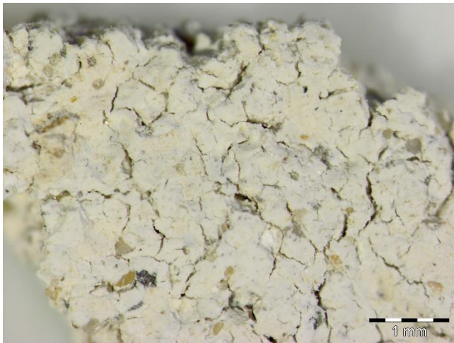
241. kép. Erősen megrepedezett a falképeket hordozó vakolat, Fertőd, Esterházy-kastély, Bábszínház leletanyag, (szm. 2,5 x obj.)
