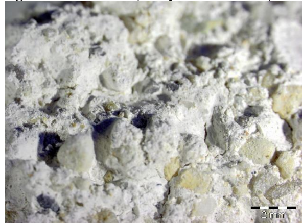
30. kép. Az alapvakolatból származó minta (SV1.) törésfelületének mikroszkópos képe, (szm. 0,8 x obj.)
