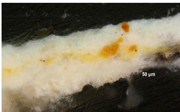
120. kép. Keresztmetszet-csiszolat normál megvilágításban (S8. minta), PLM., 20 x obj.
