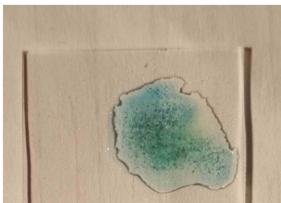
125. kép. Mikrokémiai teszt a vastartalom kimutatására (normál felvétel)
