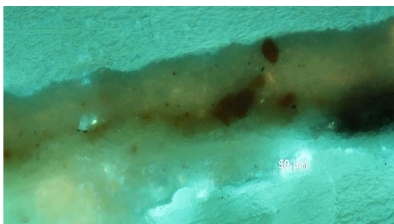
121-122. kép. Keresztmetszet-csiszolat BV és UV gerjesztésben (S8. minta), PLM., 20 x obj.
