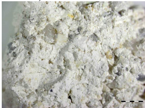
31. kép. A simítóvakolatból származó minta (SV2.) törésfelületének mikroszkópos képe, (szm. 0,8 x obj.)
