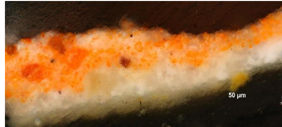
95. kép. Keresztmetszet-csiszolat normál megvilágításban (S4. minta), PLM., 10 x obj.
