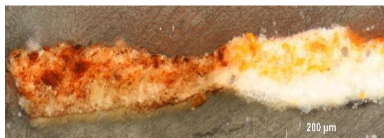
98-99. kép. Keresztmetszet-csiszolaton végzett teszt ólomtartalom kimutatására (S4. minta), PLM., 10 x obj.
