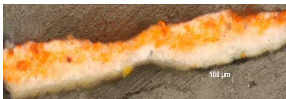
98-99. kép. Keresztmetszet-csiszolaton végzett teszt ólomtartalom kimutatására (S4. minta), PLM., 10 x obj.
