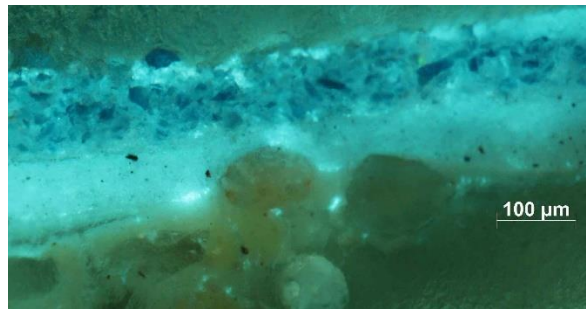
75-76. kép. Keresztmetszet-csiszolat normál megvilágításban és UV-BV gerjesztésben (S1/C. minta), PLM., 10 x obj.
