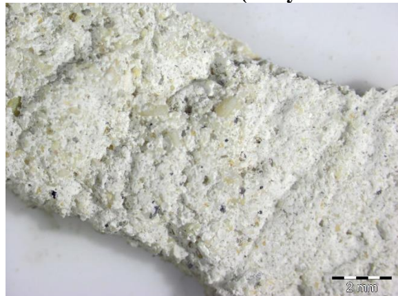
33. kép. A festővakolatból származó minta (SV3.) törésfelületének mikroszkópos képe, (szm. 0,8 x obj.)
