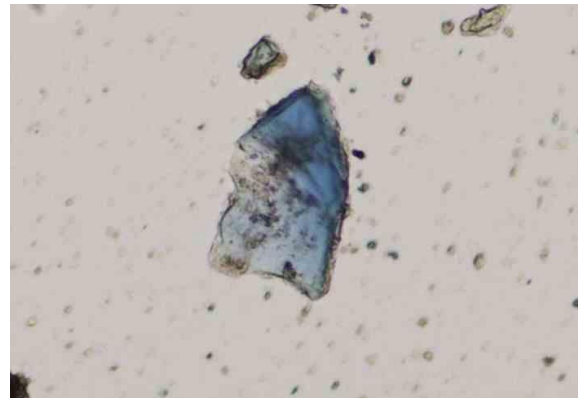
142-143. kép. A szemcsepreparátumban megfigyelhető smalte szemcsék (F1. minta), PLM., 20 x obj.
