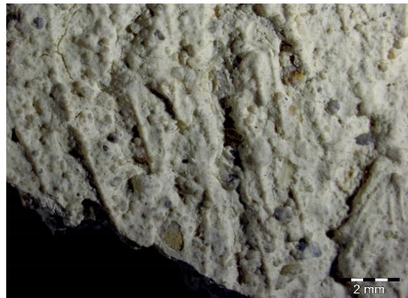
32. kép. Sűrű-fényes megvilágításban megfigyelhető simítóeszköz nyomok (az SV2. minta felülete, szm. 0,8 x obj.)
