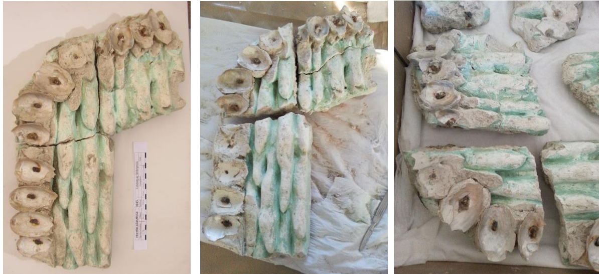
216-217-218. kép. Kagylósorral díszített mohás sziklát imitáló stukkótöredék restaurálásának fázisai
