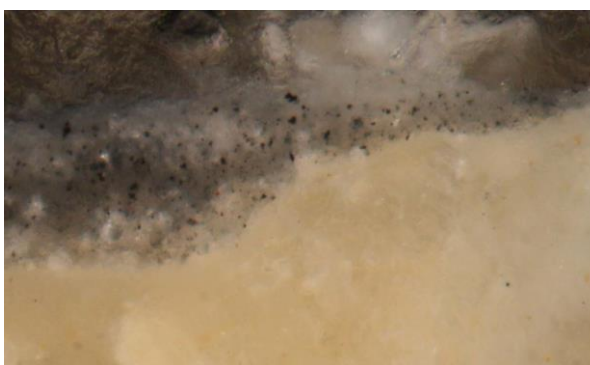
127. kép. Keresztmetszet-csiszolat normál megvilágításban (S10. minta), PLM., 20 x obj.
