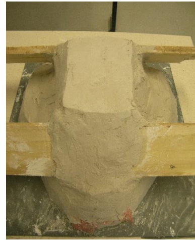
203. kép. Műanyag hálóval és fa elemekkel megerősített gipsznegatív
