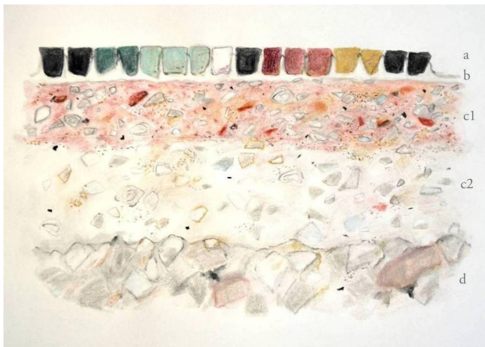
25. kép A szerző vázlata a balácai tablinum mozaik rétegről (a tesserae, b supranucleus, c1 nucleus felső rétege, c2 nucleus alsó rétege, d rudus).
