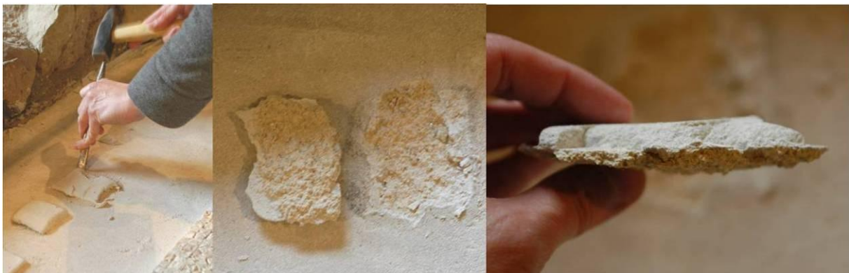
76-78. kép A beágyazó habarcs ragasztópróbái az aljazaton.
