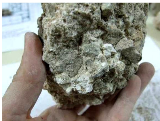
46. kép Valószínűsíthetően a 20-as terem mozaikjához tartozó töredék, melynek alsó részén megmaradt a rudus réteg egy része, melyben durva, 2-3 cm-es nagyságú kövek (valószínűleg dolomit) láthatóak.
