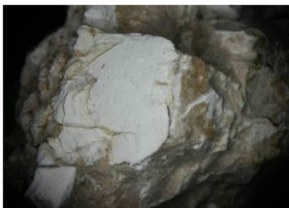
43. kép A fehér beágyazó habarcs (supranucleus) sztereo-mikroszkópos felvételen.
