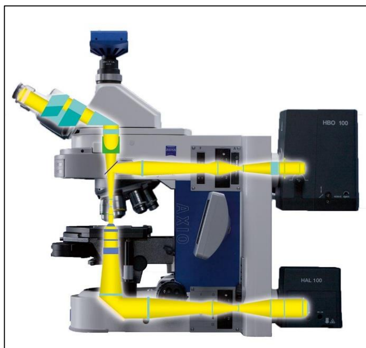
103. ábra - A Zeiss Axio Imager rendszerű polarizációs optikai mikroszkóp fényútjainak egyszerűsített ábrája (ráeső átmenőfényes vizsgálati típus egyaránt feltüntetve).
