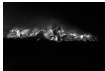
227. ábra - A BL2-es szektorból vett minta keresztmetszet-csi-szolatának polarizációs mikroszkópos felvétele, IR-L_UV 365 (10x okulár, 20x objektív).
