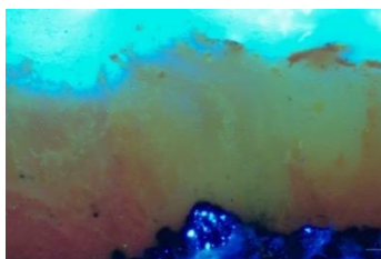
198. ábra - Az Y18-as szektorból vett minta keresztmetszet-csiszolatának polarizációs mikroszkópos felvételei, balról jobbra: VIS-L_UV 365 (10x okulár, 20x objektív).
