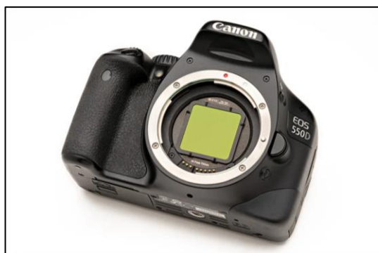
106. ábra – Egy Canon APSC vázba beillesztett szűrő.
