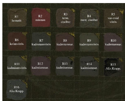
83. ábra – A vörös pigmentmezőkről készült VIS-R_VIS balra; ultraibolya false color kép jobbra; Phase One IXH, 72 mm, ISO 50, f/8.0, 1/2 sec VIS, ISO 50, f/8.0, 8 sec UVR; R1 hematit, R2 mínium, R3 természetes cinóber; R4 mesterséges cinóber, R5 mesterséges vas-oxid vörös, R6 krómvörös, R7 kadmiumvörös, R8 kadmiumnarancs, R9 kadmium vörös, R10 kadmium narancs, R11 kadmium vörös, R12; kadmium narancs, R13 kadmium narancs, R14 kadmium narancs, R15 alizarin krapplakk, R16 alizarin krapplakk.
