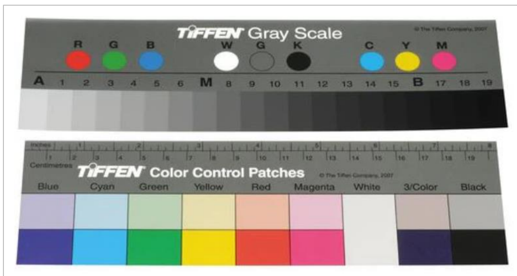
23. ábra - Kodak Color Control Patches és Gray Scale (jelenleg a The Tiffen Company gyártja).
