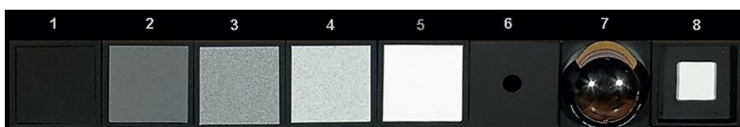
13. ábra - Az említett egyedi referenciaskála és elrendezése. 1-5: diffúz reflexió 2–99%-os PTFE felületei, 6: 100%-os elnyelő felület fénycsapdával, 7: 100% reflexiós felület, polírozott félgömb, 8: lumineszcens felület, lumineszkáló fehér pigmentbevonat. A skálát Roland Lenz, ABK Stuttgart készítette.
