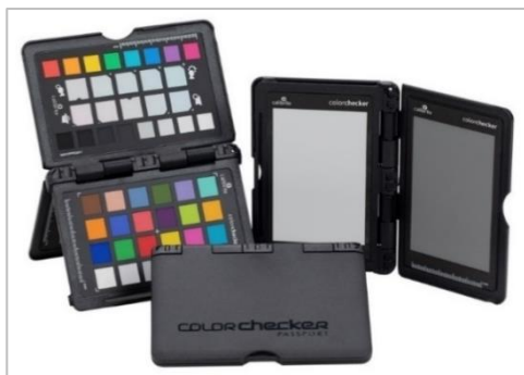
17. ábra - A Calibrite ColorChecker® Passport tartalmazza a szokásos Classic foltokat, valamint egy Photo Enhancement foltkészletet és két nagyobb fehér egyensúly mezőt, egy kemény műanyag tokban.
