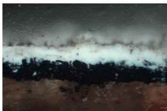
140. ábra - A W10-es pigment-mezőből vett minta keresztmetszet-csiszolatáról készült VIS-R_VIS (pol) felvétel. Forrás: saját felvétel
