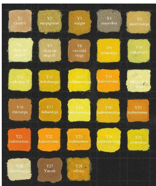
82. ábra – A sárga pigmentmezőkről készült VIS-R_VIS balra; ultraibolya false-color kép jobbra; Phase One IXH, 72 mm, ISO 50, f/8.0, 1/2 sec VIS, ISO 50, f/8.0, 8 sec UVR; Goethit, Y2 auripigment, Y3 realgár, Y4 masszikot, Y5 nápolyi sárga, Y6 ólom-ón sárga I., Y7 ólom-ón sárga II., Y8 mesterséges vas-oxid sárga, Y9 krómsárga, Y10 cinksárga I., Y11 cinksárga II., Y13 kadmium sárga, Y14 kadmium sárga, Y15 nikkel-titán sárga, Y16 titán-sárga, Y17 indiai sárga, Y18-Y24 kadmium sárgák, Y25 krómsárga, Y26 nápolyi sárga, Y27 jarosit.
