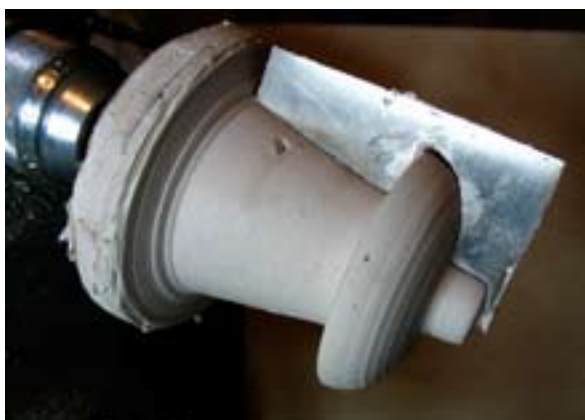
175. ábra: A mag tökéletes formájának kialakításához a már kivágott profilt használtam
