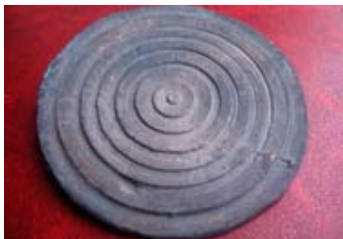
145. ábra: A második, ugyancsak gyúrt viaszból esztergált tükörmodell, magas-öntartalmú bronzötövetének nyers öntvénye
