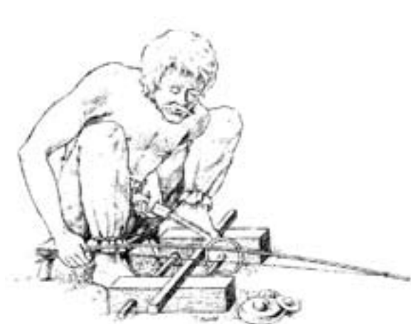
58. ábra: Kelta eszterga rekonstrukció használat közben, Kr. e. 4. század
