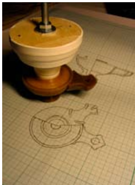
184. ábra: A mécses-orr illesztési próbája
