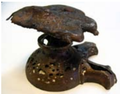
190. ábra: Az első viaszmécses nyers öntvénye, a talpából kiálló öntési csonkkal és a beágyazóanyag tetején szétterülő bronzolvadékkal. A mécses felületén látható lyukak illetve zárványok a belső mag csekély gázáteresztő képességének az eredménye
