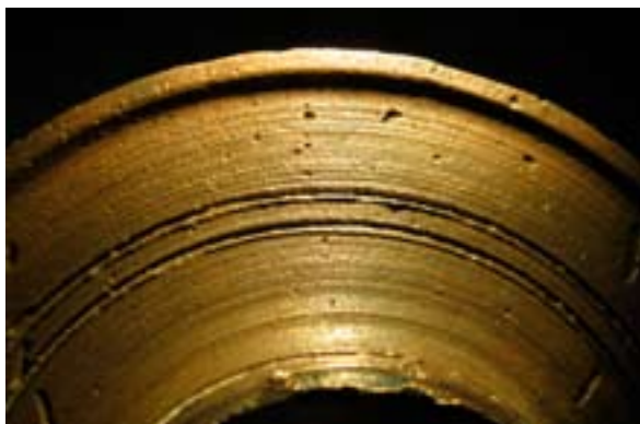
194. ábra: A nyers öntvény discusán látható koncentrikus barázdák és árkok
