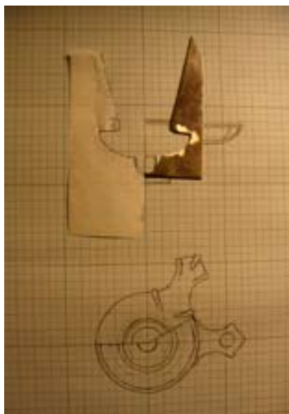
170. ábra: A belső mag profiljának elkészítéséhez átmásolt és kivágott rozsdamentes acéllap.
