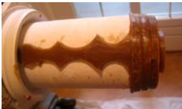
160. ábra: Az elkészült viaszmodell a tojássor-díszítmény bebélyegzése előtt
