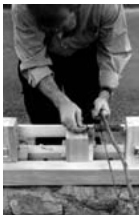
65. ábra: Íjhajtásos eszterga rekonstrukciója. A megmunkálandó anyag a befogó pofán kívül helyezkedik el
