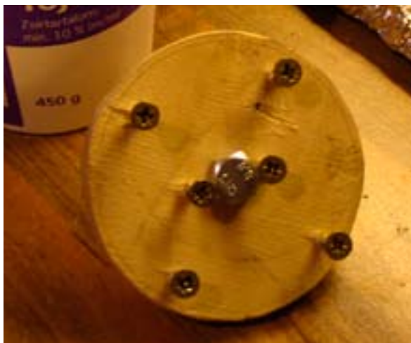
171. ábra: A rétegelt lemezből kivágott korong előkészítése a gipszmag kialakításához
