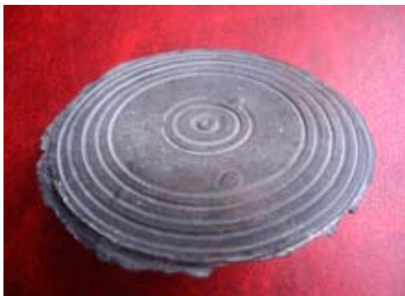
146. ábra: A harmadik, a magra ecseteléssel felvitt viaszból esztergált tükörmodell magas-öntartalmú bronzötövetének nyers öntvénye
