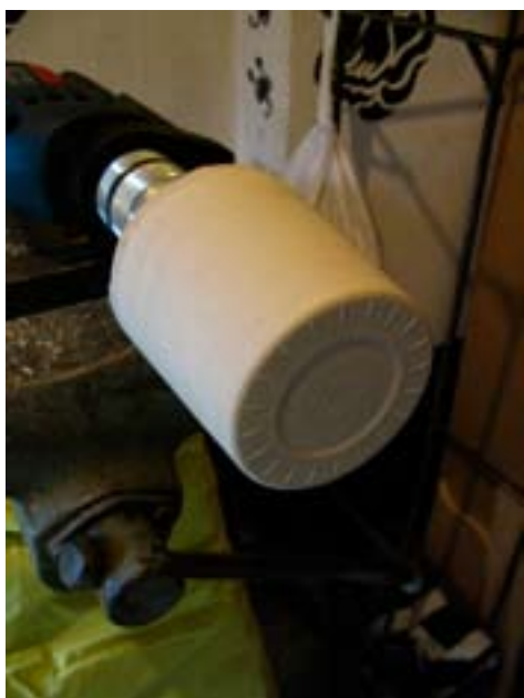
173. ábra: A megkötött, de még nedves gipszet, satuval rögzített fűrőbe fogtam
