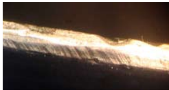
7. ábra: A peremen látható szerszám okozta nyomok nem láthatóak a tükör élének teljes keresztmetszetén
