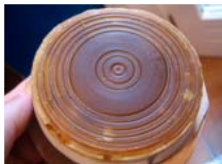
143. ábra: A tükör kész viaszmodelljének koncentrikus bordákkal díszített hátoldala
