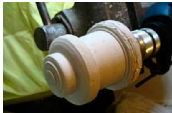
174. ábra: A mécses magjának kialakításához lenagyoltam a gipszet
