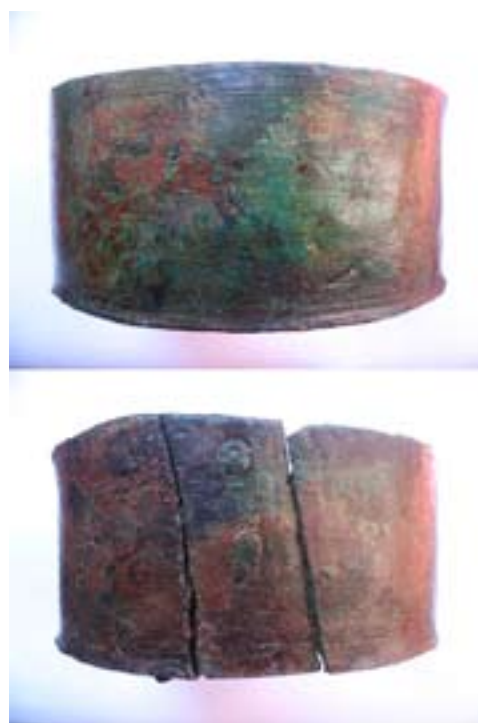
130. ábra: Római lovas kocsi 3. számú kerécsapágy törött perselyének javítása belülről, átlapolással történt. A fémlemez 6 szegeccsel rögzítették
