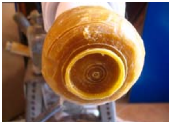
153. ábra: A gipsz mag és a viasz közt hiányzó kötés következtében a modell folyamatos mozgásban volt, ami egyenetlen felületet eredményezett
