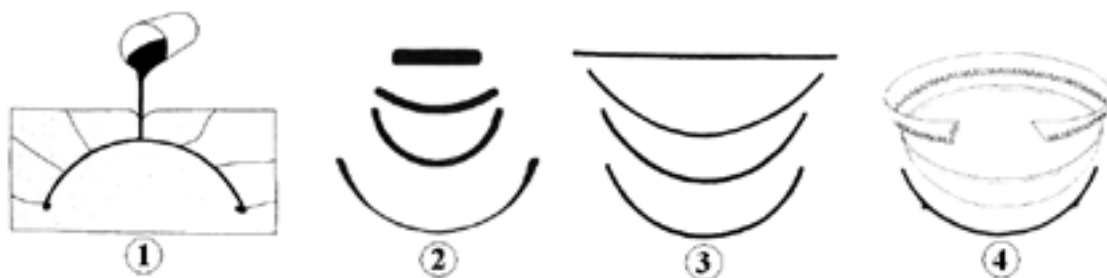
74. ábra: A fémedények készítésének négy elméleti lehetősége: 1. Közvetlen öntés, 2. Felhúzás, 3. Fémnyomás, domborítás, 4. Összetett edények, applikálás
