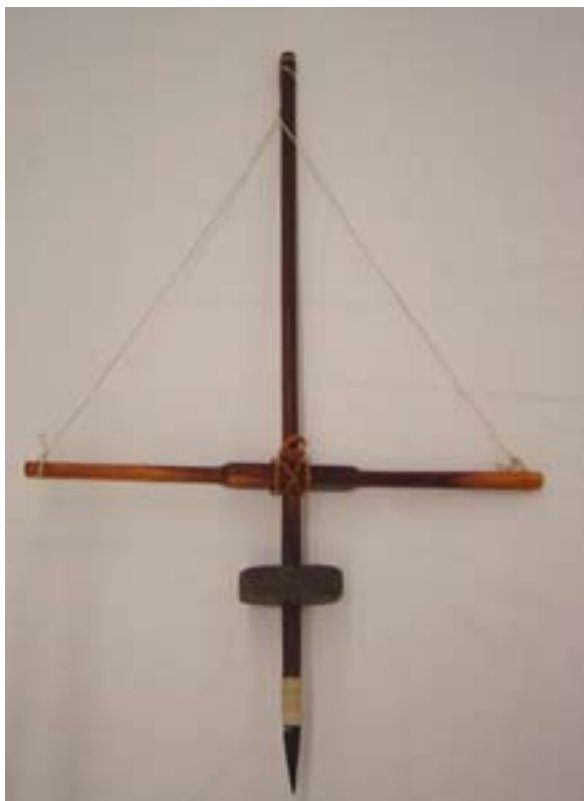
56. ábra: Pergőfurdancs vagy keresztfűs-korongos fűró. Az egyik legkorábbi fűrésra alkalmas, összetett eszköz. Tengelye két irányba forog.
