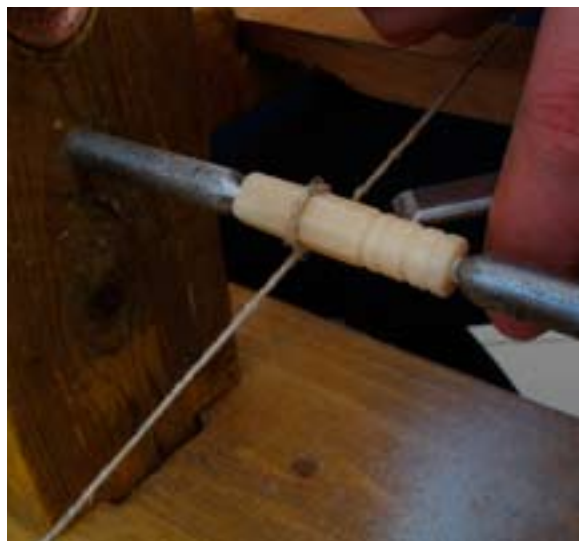
39. ábra: Az esztergálandó csonttrúd kéttuskés befogása
