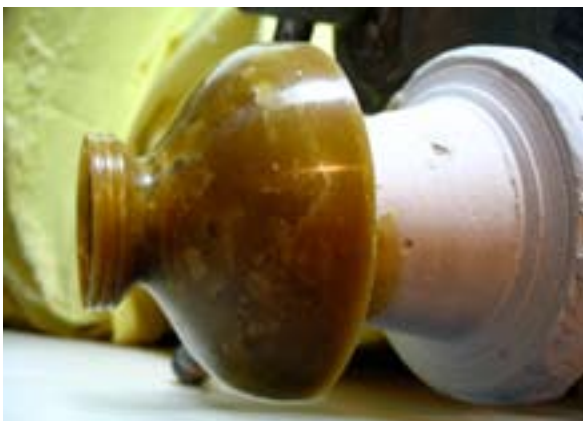
181. ábra: Miután a kés alátámasztását rögzítettem, már egyenletesebbé vált a forgácsolás. Láthatóak az ecsetelés okozta zárványok, de ha azok nem közvetlenül a külső felület alatt helyezkednek el, akkor jelenlétük nem okoz semmilyen problémát
