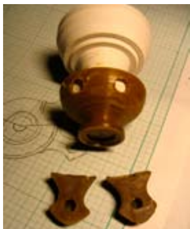
185. ábra: A mécses-test és az orrok belső magjai közti kapcsolathoz átlukasztottam a mécses falát
