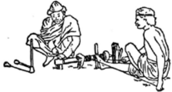
44. ábra: Indiai, egy oldalon hajtott eszterga, két irányba forgó tengellyel. Esztergakés-támasz nem látható
