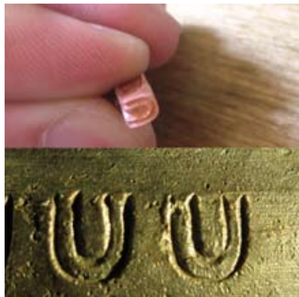
161. ábra: A tojássor-díszítés bélyegzőjét vörösrézből készítettem el, az eredetivel megegyező méretben. A bélyegzett mintát egymástól egyenlő -az eredetitől eltérően nagy- távolságra helyeztem el. Eleinte a viasz sokszor beleragadt a bélyegzőbe, ezért a viaszmodellt lehűtöttem, és a bélyegzőt olajba mártással impregnáltam. Így már az eredetivel közel azonos minőségű bélyegzéseket kaptam.
