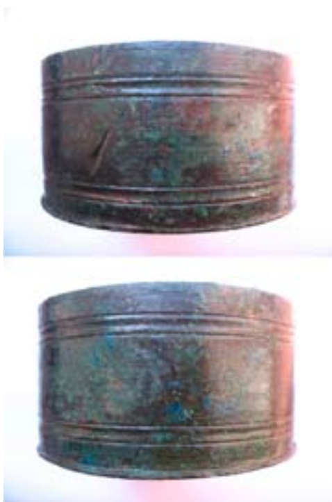
129. ábra: Római lovas kocsi 2. számú kerécsapágy perselyén látható, szabályos viaszsztergálási nyomok
