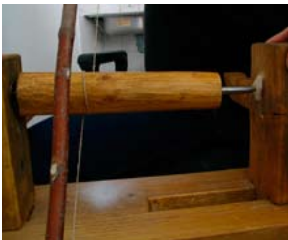
60. ábra: Az íjjal hajtott pont-kört maró szerszám
