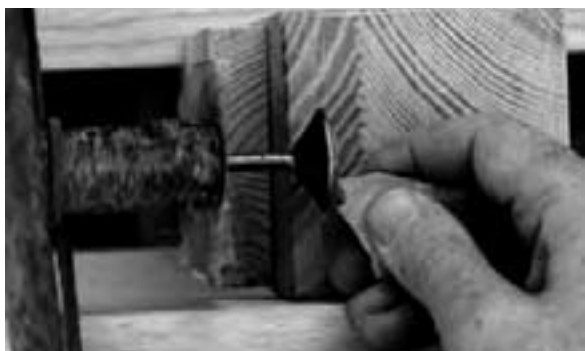
67. ábra: Az állítható befogópofa felülről nyitott
