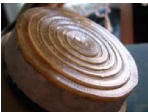
138. ábra: A viasz felületén látható sugárirányú redők
