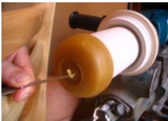
152. ábra: A viasz esztergálásánál-forgácsolásánál a leválasztott viaszforgácsot érdemes azonnal eltávolítani a késről, mert visszakenése a felületre komoly problémákat okozhat.
