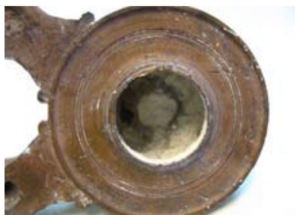
193. ábra: A viasz felültén apró bordákat és árkokat hoztam létre tudatosan, hogy megtapasztaljam milyen részletgazdag felületet lehet kapni öntés után, vagy milyen mértékű lesz a felület estleges tompulása, zavarossá válása
