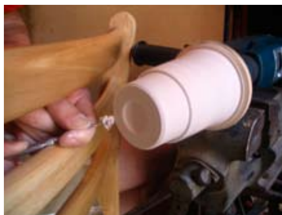
149. ábra: A gipszkeverésre használt műanyag edény formáját átvett gipsztömböt a merítő edény pereménél mért, legnagyobb átmérővel megegyező méretű rúddá esztergáltam
