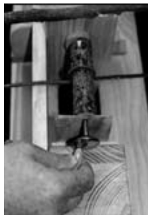
66. ábra: A megmunkálandó anyag a megforgatott tengelyhez van rögzítve
