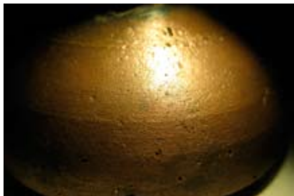
195. ábra: A mécses-test nyers öntvényén látható apró, körbefutó barázdák és árkok
