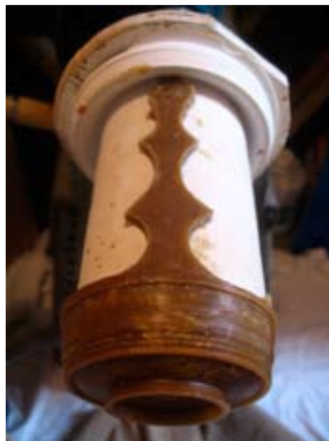
159. ábra: Az eredeti edényfülén látható díszítéseket reszeléssel is létre lehet hozni, de minden munka, mely elvégezhető a viaszmodellben azt feltehetően el is végezték a fémedények készítői
