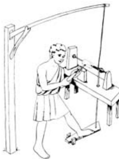
55. ábra: A római kori, póznás-pedálos eszterga meghajtó-tengelyének működését bemutató rekonstrukció (Augusta Raurica, Svájc)
