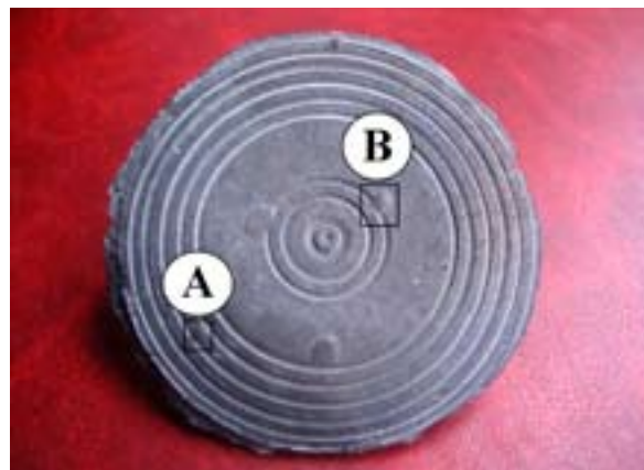
147. ábra: A harmadik ónbronztükör koncentrikus bordákkal díszített oldalán, az „A” és „B” jelzésű területen látható viaszcsepp okozta anyag többlet. Római kori bronz merítőedény anyagvizsgálata
