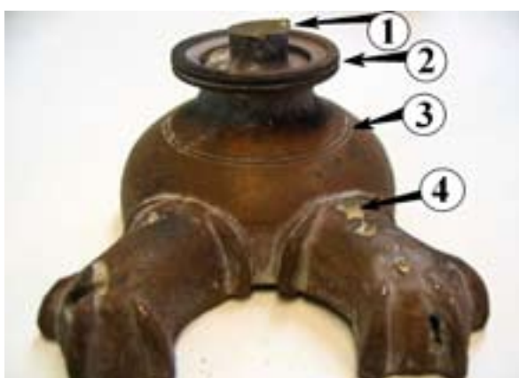
192. ábra: A második viaszmécses nyers öntvénye. 1. A talpából kiálló öntési csonk, 2. A talpat díszítő hármaskörű borda, 3. A mécses-testen körbefutó kettős vájat, 4. A beágyazóanyag tömörségéből adódó öntési hiba
