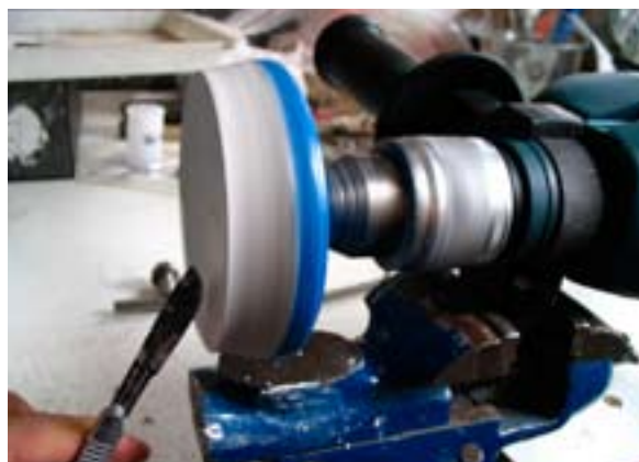
135. ábra: Modellgipszet raktam a lemez felületére, melyből -alacsony fordulaton- konkávová esztergálással alakítottam ki a magot
