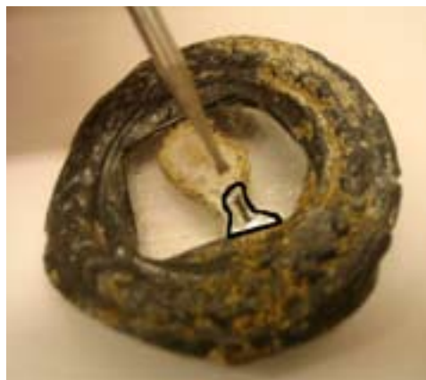
123. ábra: A fekete vonallal határolt területen az üvegre hátulról felvitt, ólomtartalmú réteg még mindig fényes fémes, és látható, ahogy tükröződik benne a fúrószár
