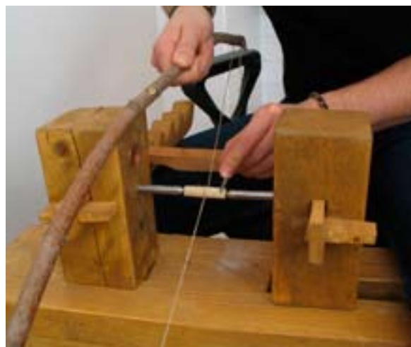
59. ábra: Az íjjal hajtott (forgatott) marhacsont esztergálása
