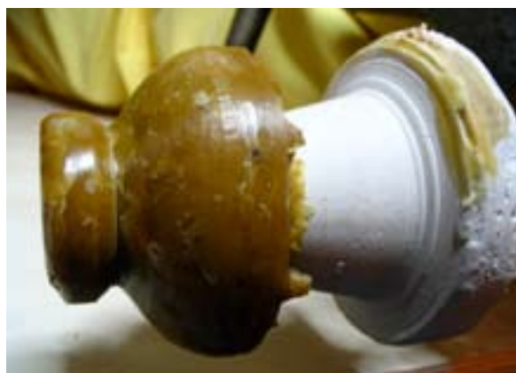
178. ábra: Az ecseteléssel felvitt viaszrétegek könnyen elváltak egymástól, ebből adódott az egyenetlen felület
