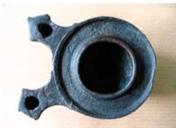
168. ábra: A mécses külső profiljának öntés utáni kialakítása esztergálással lehetetlen, mert az orrok nem teszik lehetővé a kész felületen való körbefutását
