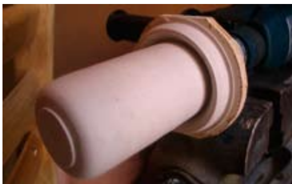
150. ábra: A gipsz rudat a merítő edény belső profiljával megegyező, pozitív formára esztergáltam
