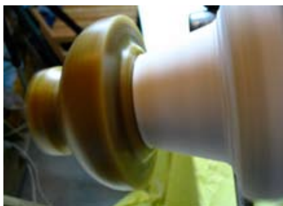
180. ábra: Az első próbálkozásnál csak kést használtam a mécsesestest profiljának kialakításához
