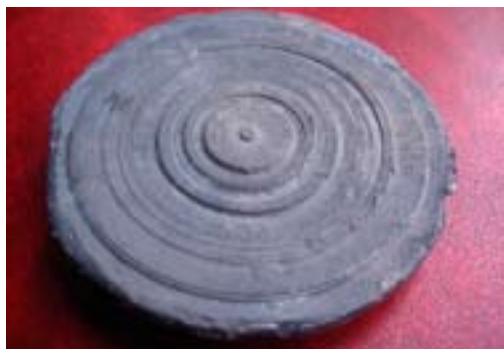
144. ábra: Az első, gyúrt viaszból esztergált tükörmodell, magas-öntartalmú bronzötövetének nyers öntvénye
