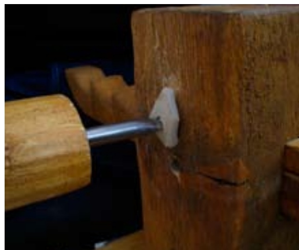
61. ábra: A meghajtás a megmunkálóeszköz forgatására irányul
