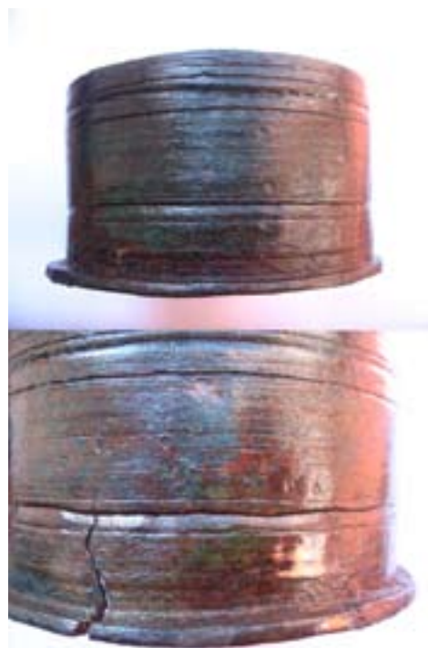
133. ábra: Római lovas kocsi 1. számú kerécsapágy perselyének másik oldalán látható szabályos és szabálytalan viaszsztergálási nyomok
