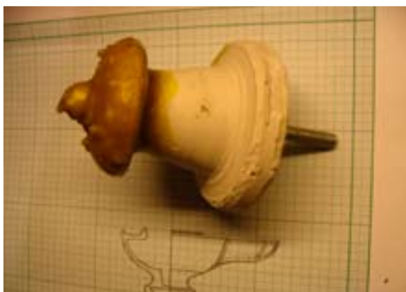
177. ábra: Első próbához ecseteléssel a másodikhoz méritéssel vittem fel a kész magra a méhviaszt
