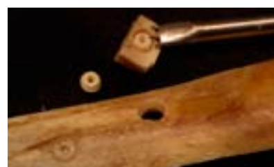
35. ábra: A pont-kört maró fúrófej megfelelő használatakor a lyukon kívül egy gyöngy nyerhető ki az anyagból
