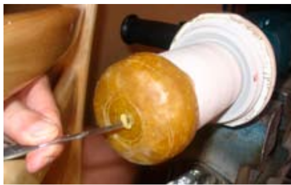
151. ábra: Első kísérletnél a kézzel gyúrt, zömített méhviaszt nyomkodtam a gipszmag végére
