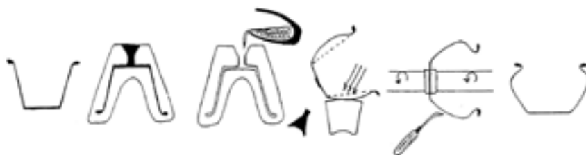
79. ábra: Fémedény készítésének folyamata. A viaszformától a kész edényig. Vajon hogy készült az ábrásor első képén látható viaszedény-modell?
