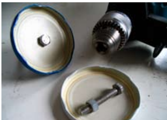
134. ábra: Egy körlemez középpontjába száras csavart rögzítettem
