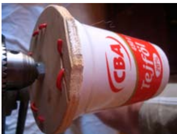
148. ábra: A rétegelt lemezről elnagyoltan kivágott korongba körbe drótot fűztem, ez biztosította a modellgipsz kemény kötését a falemezhez. A fűrőtokmányába a korong közepén keresztül haladó, hosszú szárú csavart fogtam
